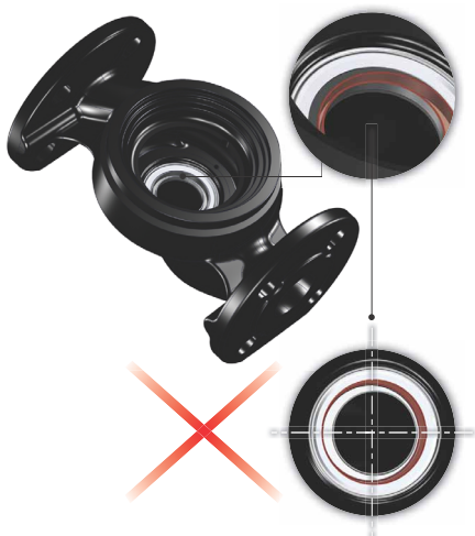
Рис. 17 Неправильно выровненная система уплотнений
