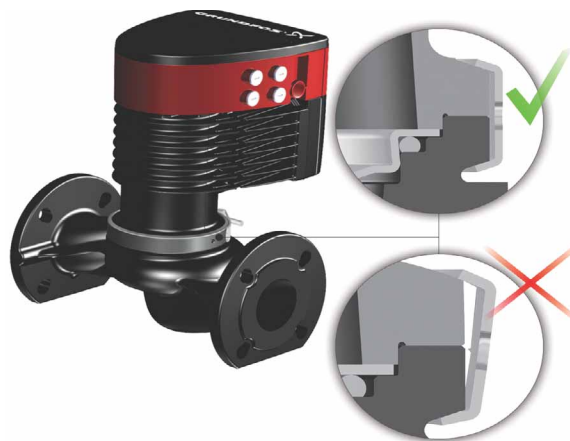
Рис. 18 Закрепление головной части насоса на корпусе
