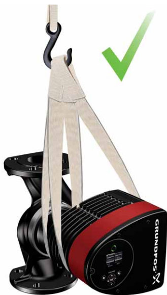
Рис. 10 Правильный способ строповки насоса
